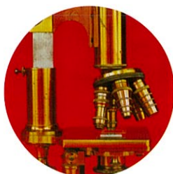
1873年 ライツ顕微鏡 回転可能支柱、 偏光アタッチメント付き
