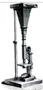
1988年～ 小型マイクロ写真装置No.35 各種顕微鏡スタンドに対応
